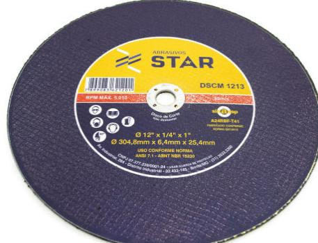
Disco de corte especial para abertura de canais e cortes diversos. É um disco reforçado, pois, possui 3 telas. Muito utilizado para abertura de canais para janelas.
