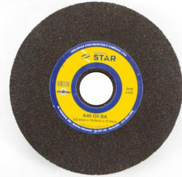
Utilizado em serralherias, caldeirarias e oficinas. Formado por resinas a base de fenóis, apresenta elevada resistência após uso da polimerização. São utilizados para desbaste em retíficas planas, com grandes áreas de contato e acabamento com grãos extra-finos.
